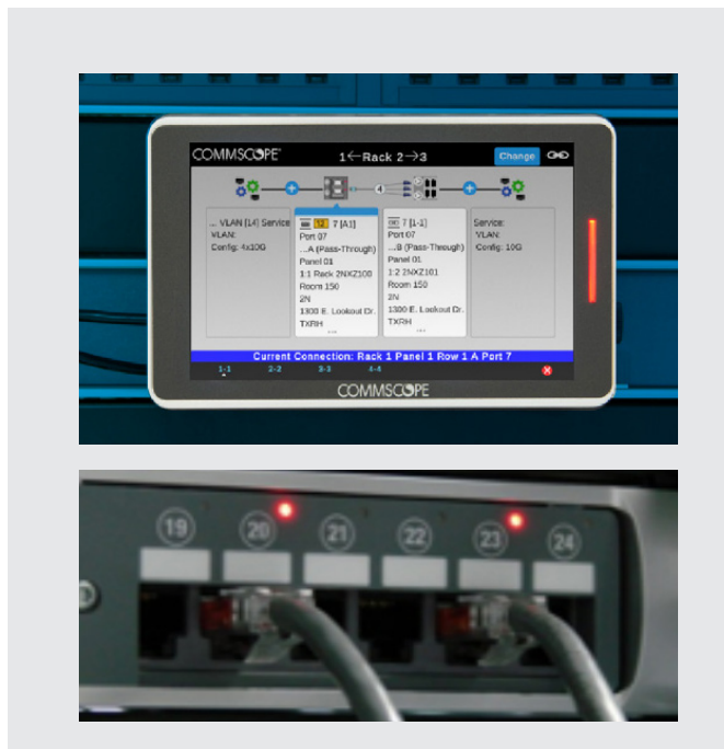
Рисунок 1. Система imVision предоставляет экранные инструкции и визуальные указания, которые позволяют обеспечить правильное подключение портов.
